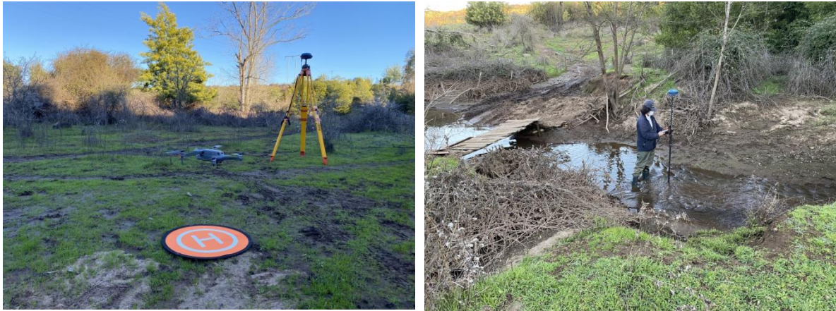
Figura 3-1. Levantamiento Topográfico mediante GPS RTK.
